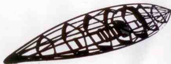
Diagonální vzpěry. Tyto činí kajak naprosto tuhý v pětých.
